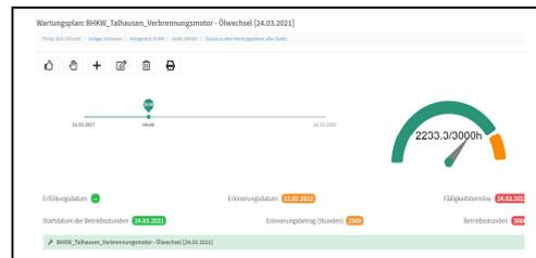
Eine vorbeugende Wartung erhöht die Verfügbarkeit und Sicherheit einer Anlage!
